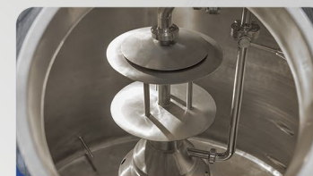
TINA DE FERVURA COM BOILER INTERNO COM SISTEMA VENTURI
