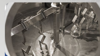
INTERNO DA TINA DE FILTRAÇÃO/CLARIFICAÇÃO
